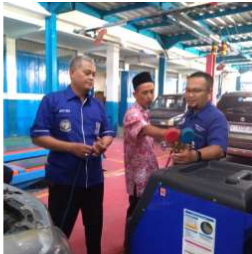
Gambar 2. Demonstrasi penggunaan alat service AC Mobil
